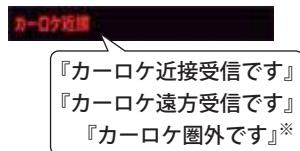
「無線自動車動態表示システム」ことで、警察の通信司令本部がパトカーなどの移動局の現在位置をリアルタイムで地図上に表示し、把握するためのシステムです。カーロケーターシステムを搭載した移動局は、GPSによる緯度・経度情報をデジタル化し、それを407.7MHz帯の周波数でデータ伝送しています。本機は、それを受信することにより、移動局が近くにいることを警報します。
