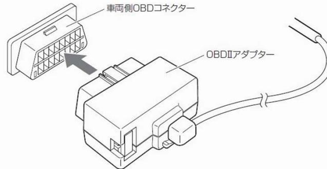
本製品(OBD II アダプター)を取付けた場合、車両OBDコネクターから外側に最大35mm製品が突き出します
