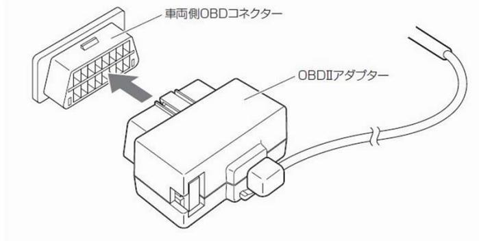
本製品(OBD II アダプター)を取付けた場合、車両OBDコネクターから外側に最大35mm製品が突き出します
